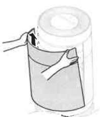
**4** Odstraňte podpěru umístěnou na vstupu filtru.
